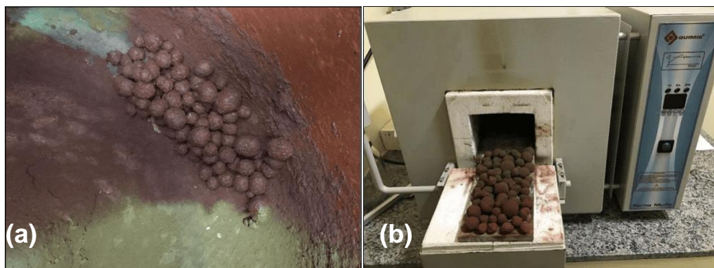
Figura 12 – (a) Formação de pelotas das misturas na betoneira; (b) Forno tipo mufla após queima do agregado.
