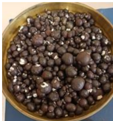
Figura 14 - Aparência dos agregados sintéticos peletizados após a sinterização.
